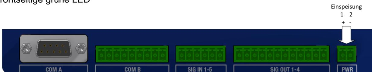
„Power“ signalisiert. Die interne Geräteversorgung ist von der Einspeisung isoliert ausgeführt. Die Einspeisung wurde mit einem zweipoligen Steckverbinder realisiert und ist mit „PWR“ gekennzeichnet.
