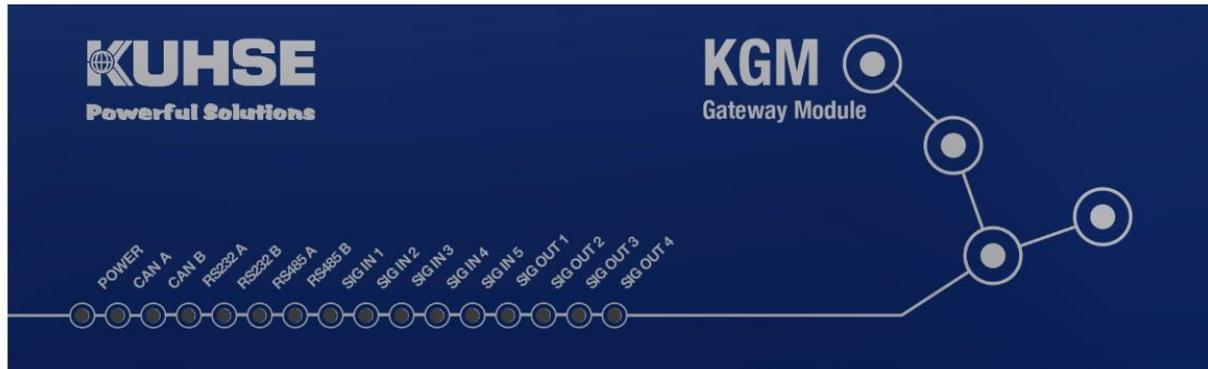
Das Gerät verfügt frontseitig über insgesamt 16 LED's. Die Ethernet-Ports ETH A und ETH B verfügen über eigene LED's für „Link“ und „Traffic“ direkt an den Ethernet-Anschlüssen.
